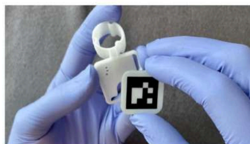
4. Inserirlo nella base del marcatore e verificarne l'adattamento
